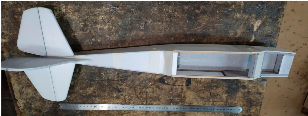
Устанавливаем коробочки для крепления сервоприводов, в качестве тяг используется стальная проволока диаметром 0.7 - 0.8 мм, находящаяся в боудене «фото 2.8».
