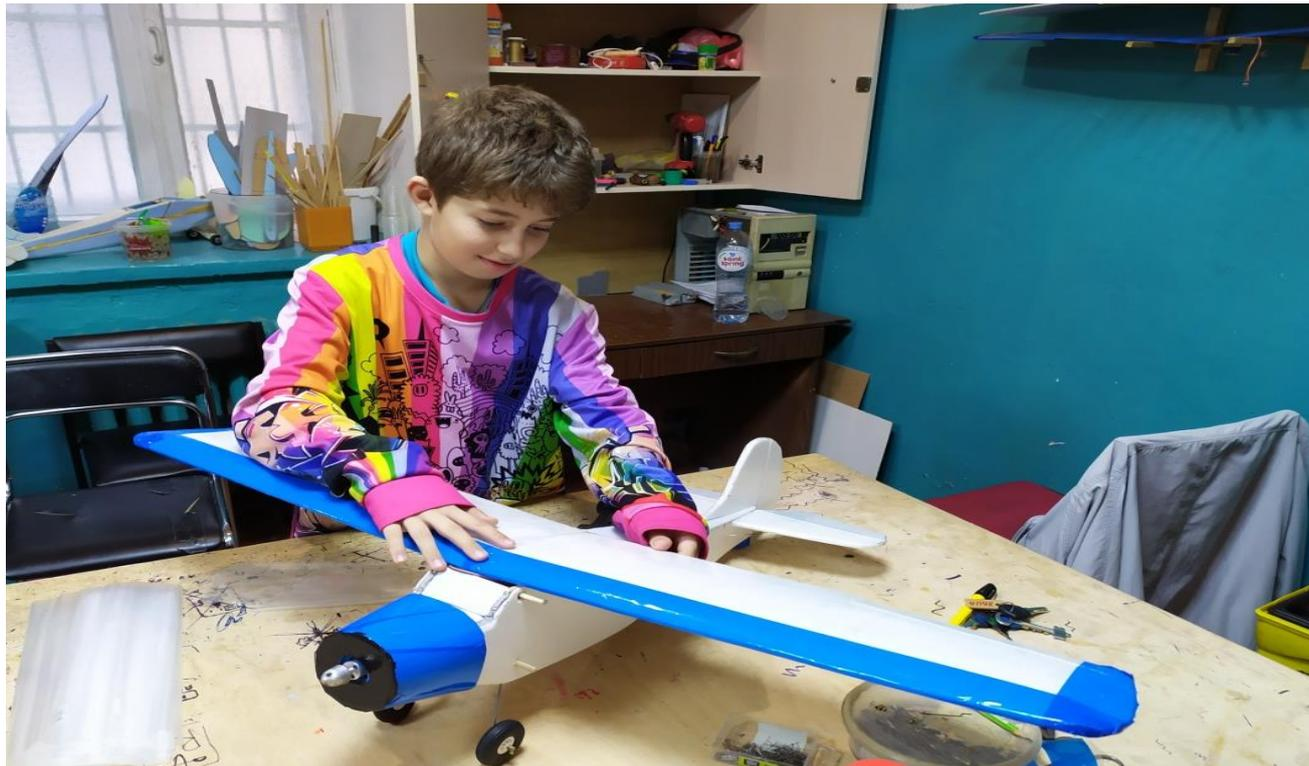
Вторая модель Cessna 185 Skywagon. Технология изготовления аналогична ЯК-12А. Отличие в очертании фюзеляжа, крыла, хвостового оперения. Отсутствует накладной капот. Упрощен механизм управления в хвостовой части фюзеляжа, а именно руль направления не задействован, а сервопривод руля высоты вынесен в хвостовую балку и имеет внешнюю тягу.
