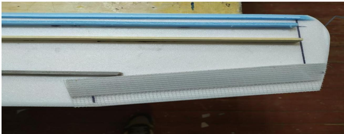
Вырезаем и наклеиваем верхнюю панель крыла «фото 2.12».
