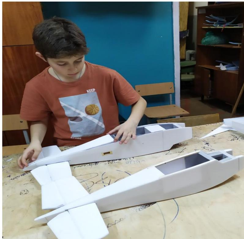
Устанавливаем коробочки для крепления сервоприводов «фото 2.22».
