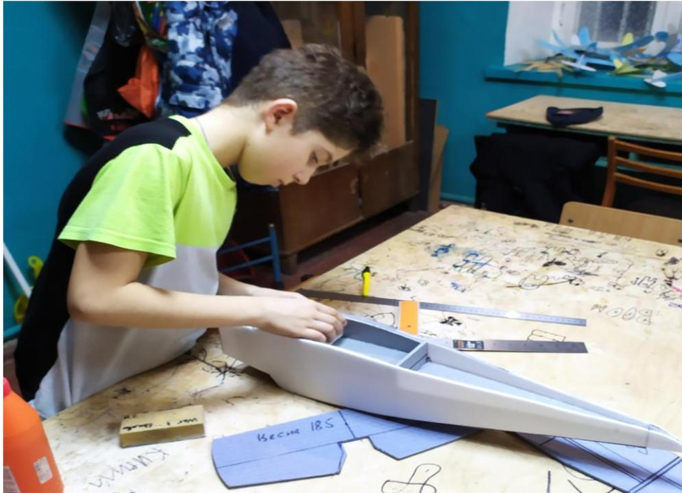
Изготавливаем и устанавливаем стабилизатор и киль «фото 2.21».
