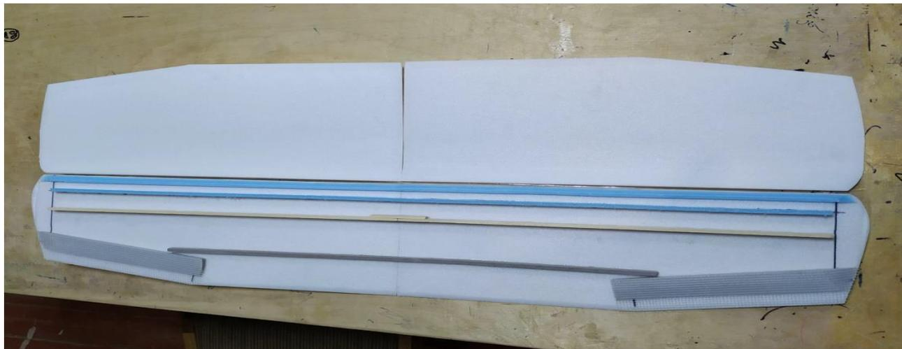
Крыло обрабатываем, прорезаем элероны, обклеиваем скотчем «фото 2.13».
