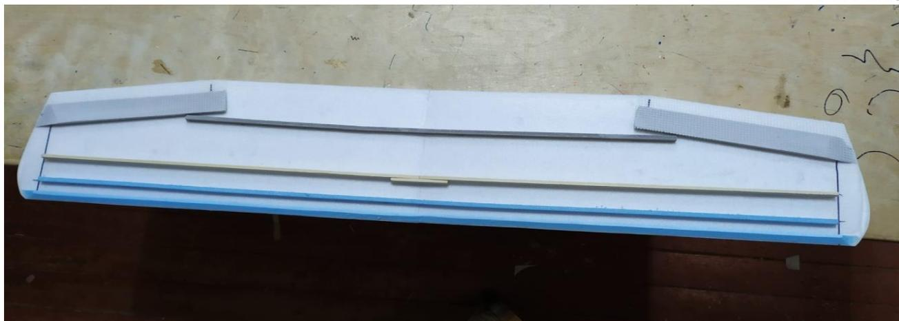
Для создания в крыле элерона, вклеиваем клиновидную вставку и наклеиваем серпянку «фото 2.24».
