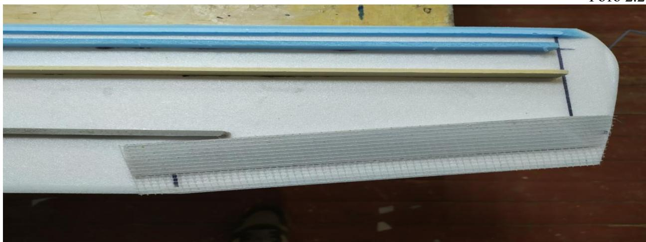
Вырезаем и наклеиваем верхнюю панель крыла «фото 2.25».
