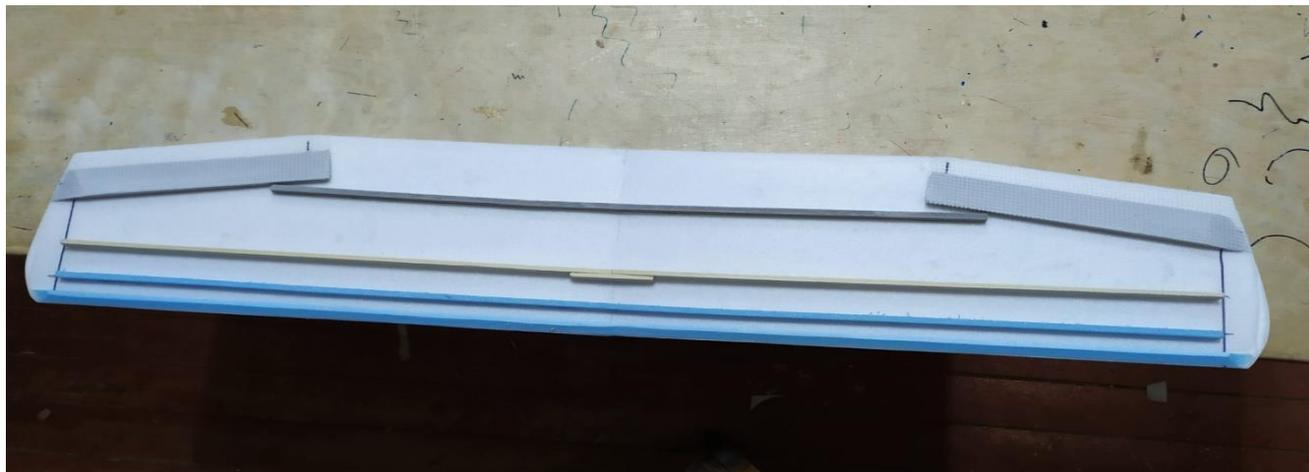
Для создания в крыле элерона, вклеиваем клиновидную вставку и наклеиваем серпянку «фото 2.11».
