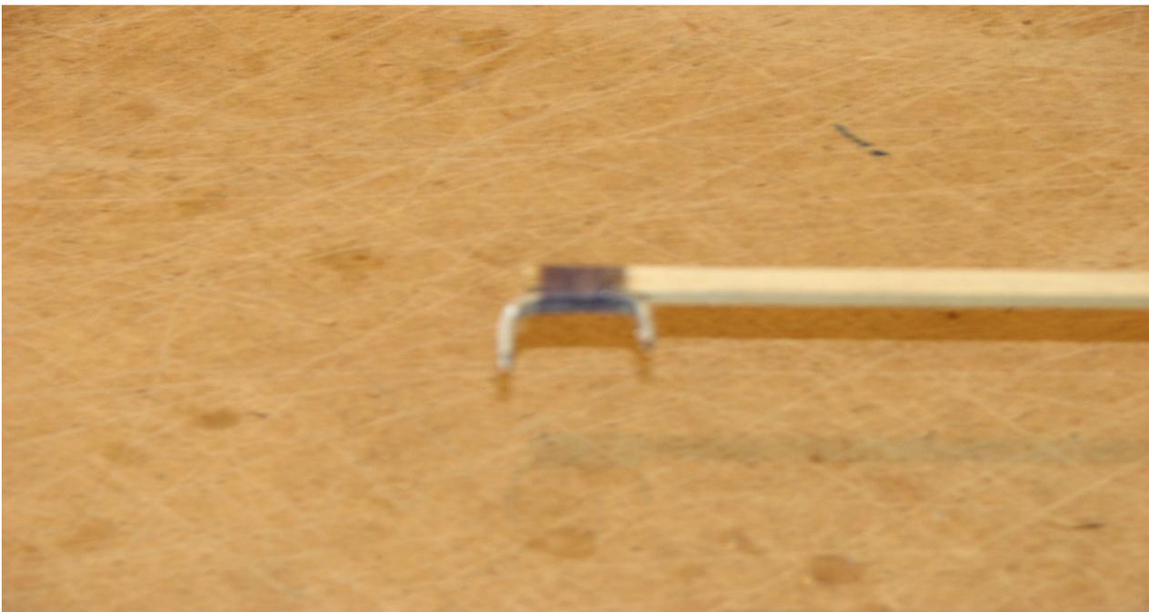
Из стальной проволоки диаметром 0.8 мм выгибается крючок, согласно чертежу. Крючок приматывается нитками в точке, согласно рисунку-чертежу. Нитки фиксируются суперклеем. К деревянной рейке клеится пилон (фото №16)
