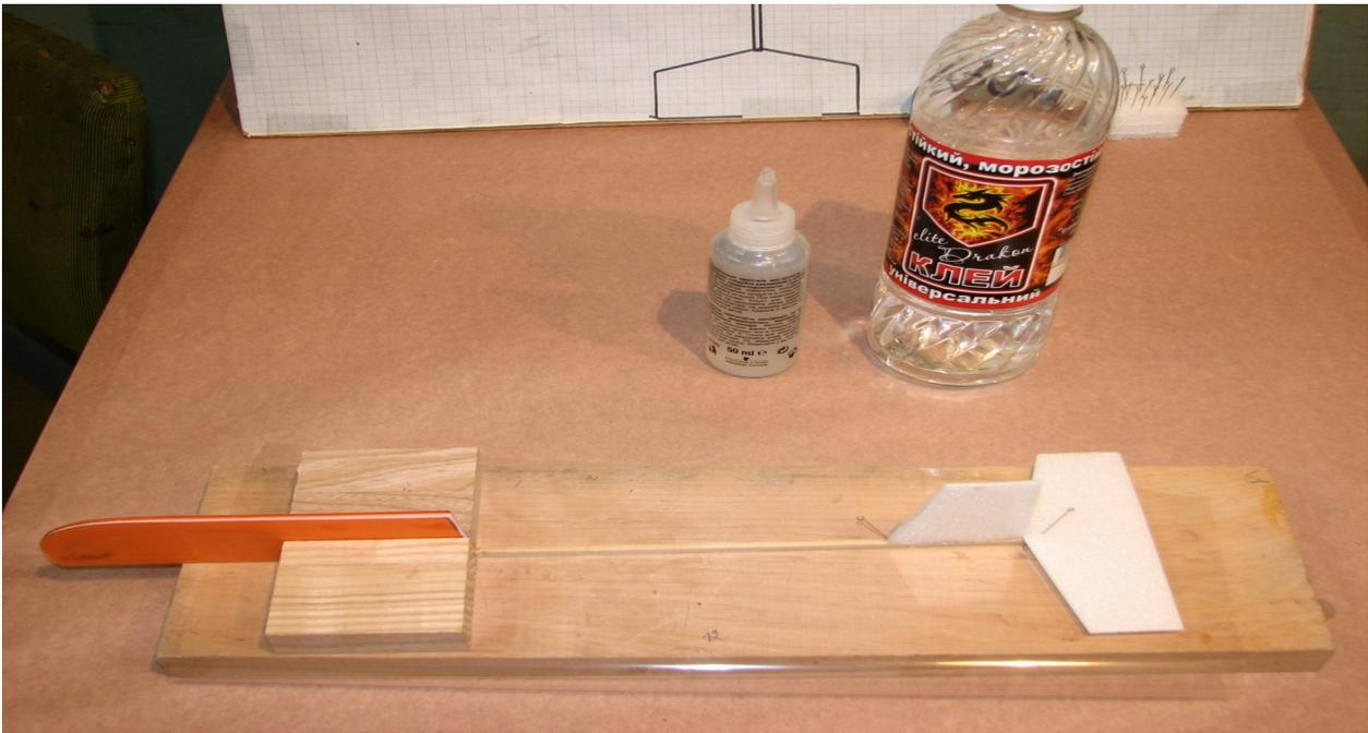
Затем делается крыло. На вырезанном и обработанном крыле по линии средней хорды под линейку проводится линия. Цель этой линии – создать небольшое углубление, по которому делается прогиб. Прогиб сверху фиксируется полоской скотча (фото 8).
