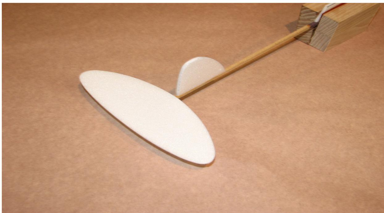
Особое место занимает изготовление винта. Из сосновой рейки 4x4 мм и длиной 40 мм изготавливается ступица винта. Для этого по торцам заготовки по диагоналям квадрата сечения лобзиком делаются пропилы на глубину 10 мм. Плоскости пропилов пересекаются под прямым углом. Согласно рисунку-чертежу, из проволоки 0,8 мм выполняется ось пропеллера. Ось приматывается к ступице нитками и фиксируется суперклеем (фото 18).
