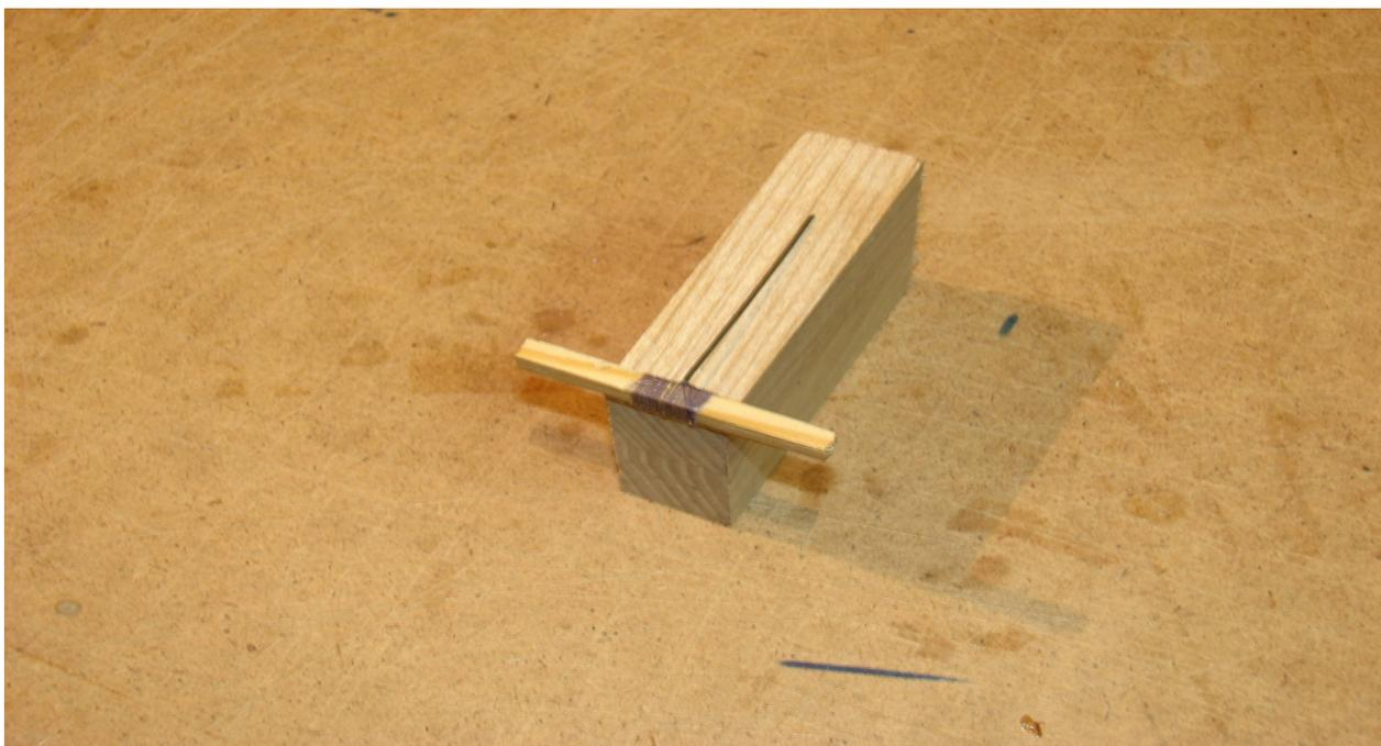
Пропилы в ступице должны соответствовать вращению винта против часовой стрелки по направлению полета. Лопасти винта изготавливаются из цилиндрической части пластиковой бутылки. Вырезаются ножницами по шаблону и вставляются в пропилы ступицы. Фиксируются суперклеем (фото 19).
