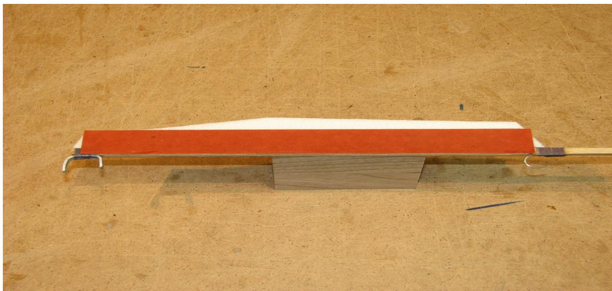
Вырезаются, обрабатываются киль и стабилизатор. Также клеятся к хвостовой балке (фото 17).
