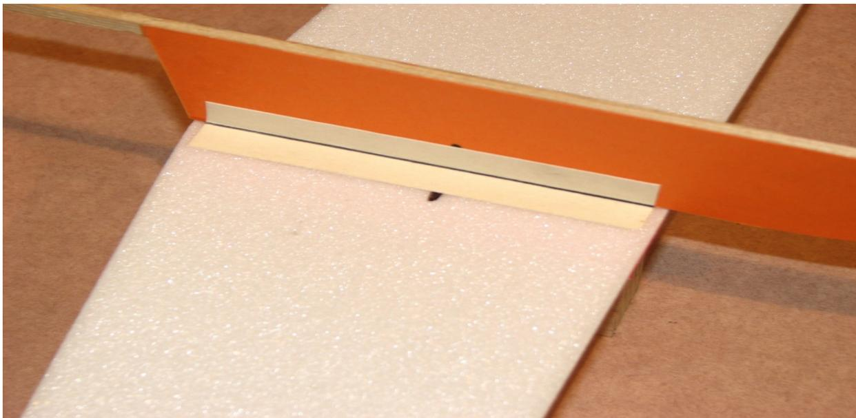
Таким образом, мы получаем центровку 50%. Крыло приклеиваем клеем «Дракон» к верхней части пилона и фиксируем булавками. Для усиления этого узла приклеиваем два уголка из плотной бумаги (ватмана). Даем модели время на высыхание клея более двух часов и модель готова (фото 10).
